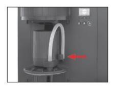
An der rechten Seite der Mischeinheit befindet sich der Entriegelungsgriff. Vor dem Drucken des Griffes ist die Mischeinheit mit dem Schutzlappen zu halten. Danach kann der Entriegelungsgriff betätigt und die Mischeinheit nach unten entnommen werden.
